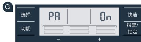
**连接失败：**请确保您的智能手机或平板电脑与家电连入同一家庭网络(WLAN)。重复步骤 3 中的操作过程。如果冰箱控制面板显示“**Er**”，您可以重置您的冰箱。请在冰箱说明书中阅读重置冰箱的说明以及其他提示。
