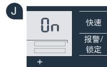
如果冰箱控制面板上显示“OF”，这意味着连接失败。请检查冰箱是否在家庭网络(WLAN)的信号覆盖范围内，如必要，请重复以上步骤。
